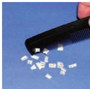
▶ شکل ۱۰۷-۲ ایجاد الکتریسیته ساکن در اثر اصطکاک
